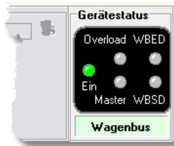
Der Gerätestatus repräsentiert die LEDs an der Frontplatte des IWT-2000 und zeigt Ihnen an, in welchem Modus sich die WBMonitor Software gerade befindet.
